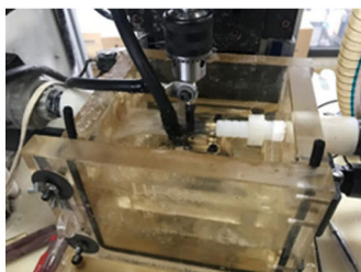
ماشینکاری الکتروشیمیایی سوپرآلیاژ تک کریستال CMSX-4
